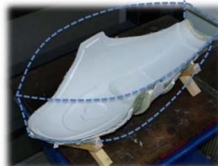
Etape 2 - Moule intermédiaire + Plages techniques verticales en thermoplastique
