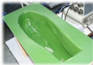
Etape 5 - Moule chauffant Réalisé par infusion, avec réseau chauffant intégré
