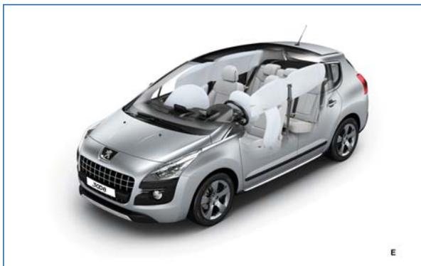
**E**n complément des performances de la structure en termes de résistance aux chocs, des éléments de protection sont développés afin de retenir et respecter le corps.
